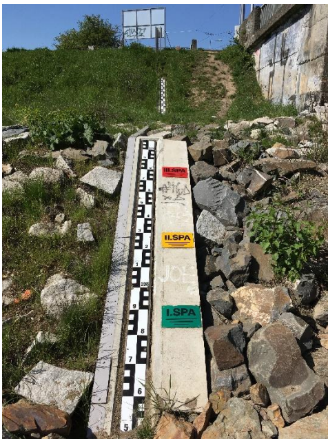
Obr. 41: Vodočetná lať reprezentující I. – III. stav povodňové aktivity na řece Moravě u silničního mostu na ulici Velkomoravská (Filip Coufal, duben 2016)
