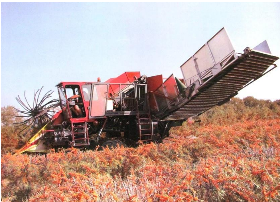
Příloha 7: Kombajn při řezu větví rakytníku (Plná zahrada, 2013)
