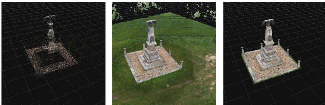
Obrázek 17: Fáze tvorby 3D modelu, zleva mračno bodů, texturovaný model, model po odstranění okolí 132
