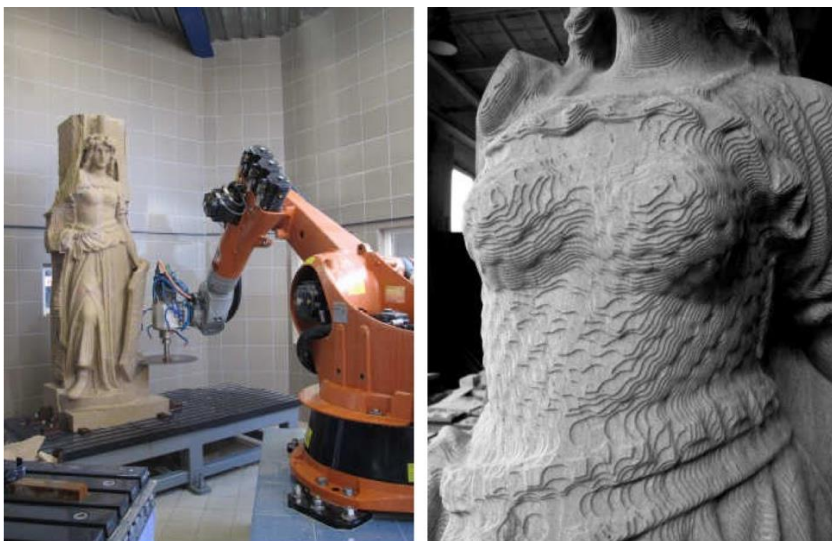
Obrázek 3: Robotické obrábění repliky Austrie 77
