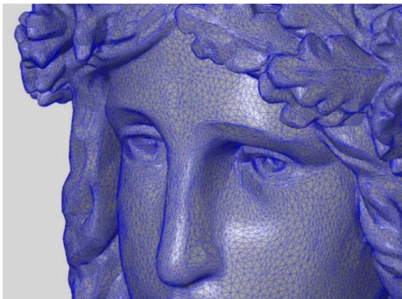
Obrázek 2: Polygonová síť modelu Austrie 74
