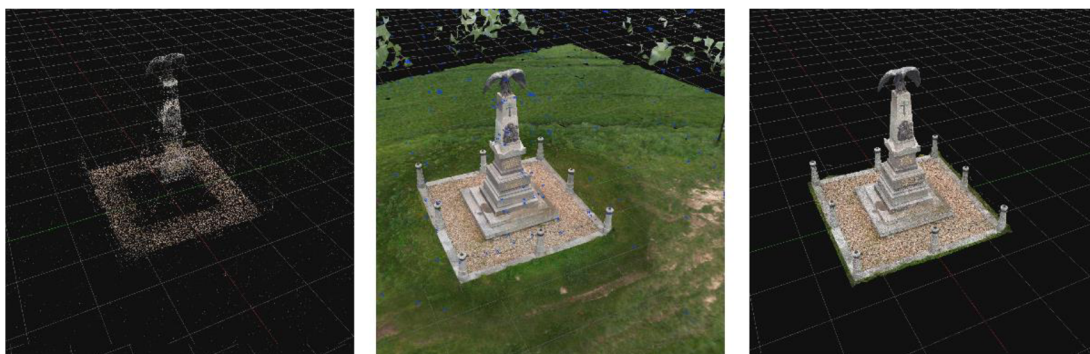
Obrázek 17: Fáze tvorby 3D modelu, zleva mračno bodů, texturovaný model, model po odstranění okolí 132
