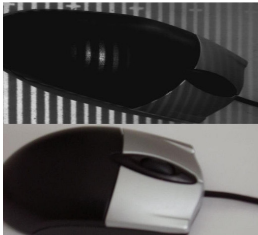
Obr. 8.17 - Předmět s nevhodným povrchem pro rekonstrukci (tmavý a lesklý)
