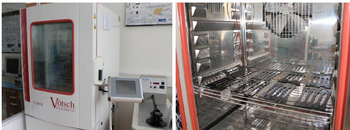
Obr. 24 Klimatická komora Vötsch VC 0018 a detail uložení vzorků
