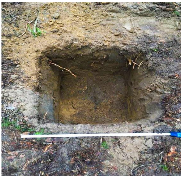
Obr. 14: Půdní sonda 50 × 50 × 60 cm
