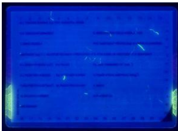
Obrázek 6 - fluorescentní ochranná vlákna viditelná pod zdrojem UV záření Zdroj: PRADO [online]. consilium.europa.eu. [citováno 17.ledna 2024]. Dostupné z: https://www.consilium.europa.eu/prado/cs/CZE-GO-01002/image-359622.html
