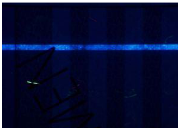
Obrázek 5 - fluorescentní ochranný proužek viditelný pod zdrojem UV záření Zdroj: PRADO [online]. consilium.europa.eu. [citováno 17.ledna 2024]. Dostupné z: https://www.consilium.europa.eu/prado/cs/CZE-GO-02001/image-356556.html
