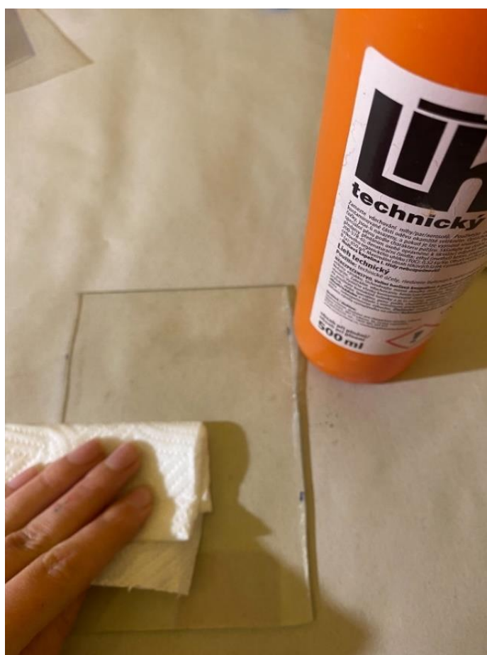
Obr. 54: Čištění skla technickým lihem
