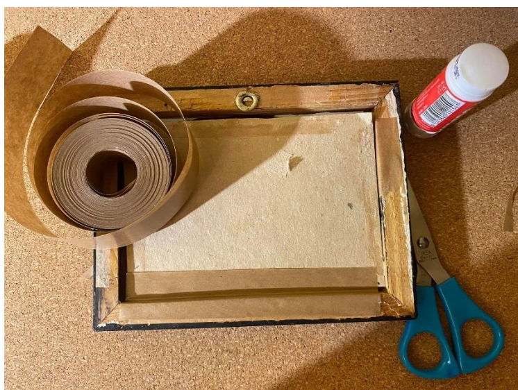
Obr. 69: Lepení rámečku papírovou páskou
