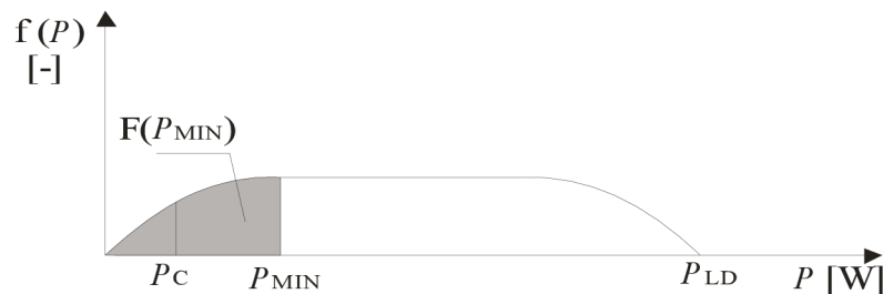
Obrázek 3.11 Graf hustoty pravděpodobnosti detekce určité hodnoty optického výkonu, kdy nedostupnost je zaviněna příliš nízkou úrovní přijatého signálu
