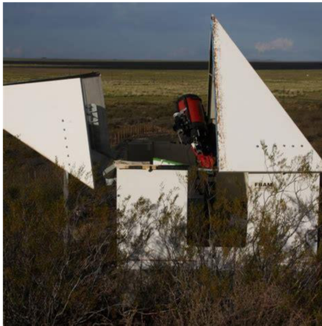
Obr. 13: Kryt FRAMu s levou polovinou otevřenou (Převzato z [3]).
