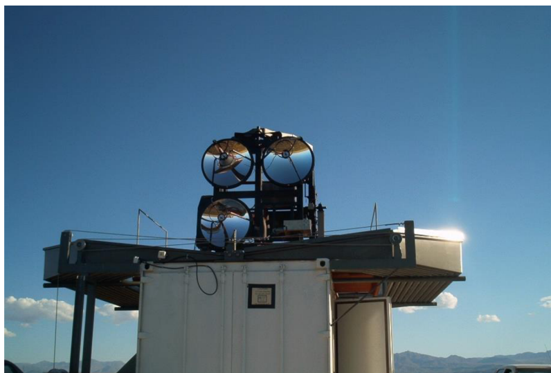
Obr. 10: Elastický lidar (Převzato z [7]).
