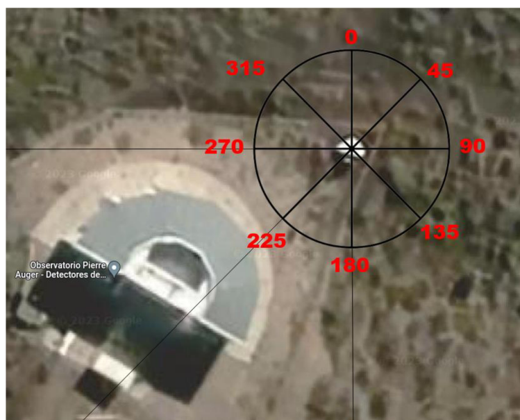
Obr. 18: Snímek z Google Maps doplněný o azimutální úhly vůči FRAMu. Z obrázku je patrné částečné „zastínění“ FRAMu stanicí FD v intervalu azimutů mezi 220° a 260° (hvězdy na nízkých výškách nad obzorem nejsou v tomto rozsahu azimutů pozorovatelné).
