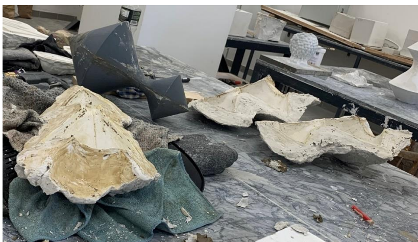
Obr. 39 Tří dílná forma a model po rozložení [35]
