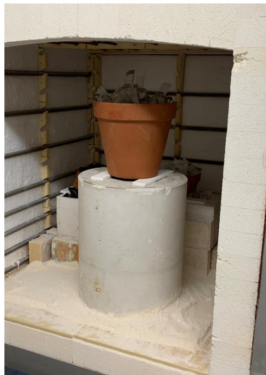
Obr. 41 Forma i se sklem připravená na tavení a sušení [35]
