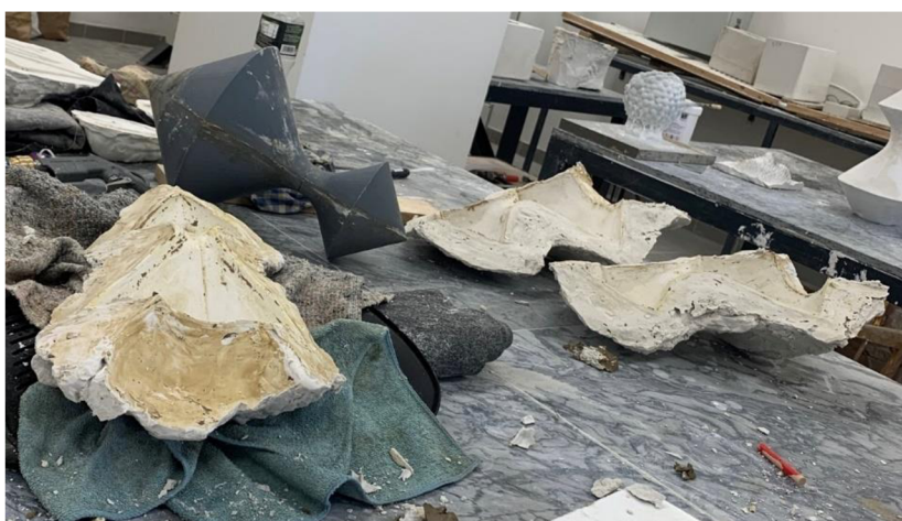
Obr. 39 Tři dílná forma a model po rozložení [35]
