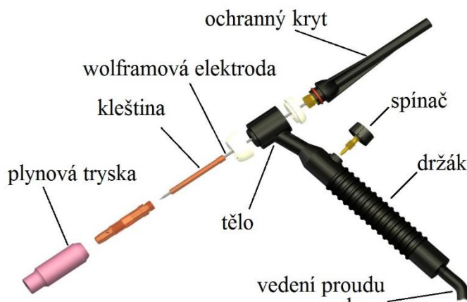
Obr. 32 Schéma svařovacího hořáku TIG [53]
