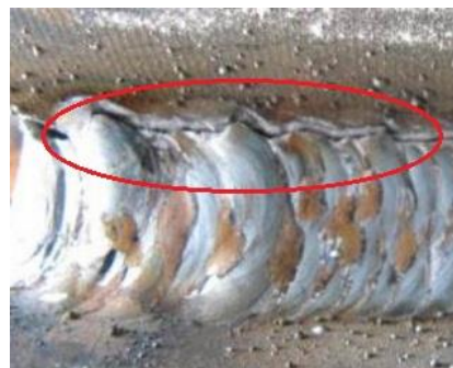
Obr. 35 Trhlina za studena [76]
