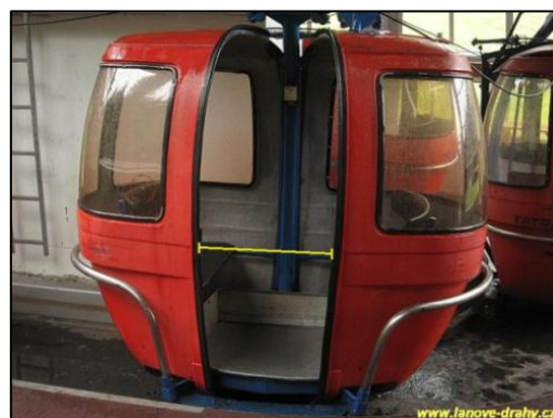
Obrázek 48. Měření šířky dveří u kabinkové lanovky
