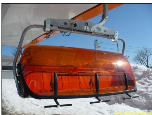
Obrázek 50. Ochranný kryt, tzv. "bublina" ( http://www.lanove-drahy.cz/?page=lan_pl&lan_pl=12 )
