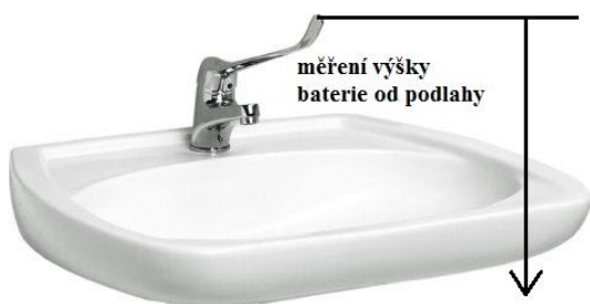
Obrázek 61. Měření výšky baterie u umyvadla ( http://www.vytapecitechnika.cz/umyvadlo-65x56x14-cm-pro-telesne-postizene-otvor-pro-baterii-bez )
