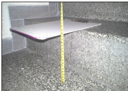
Obrázek 31. Princip měření schodů (autorský snímek)
