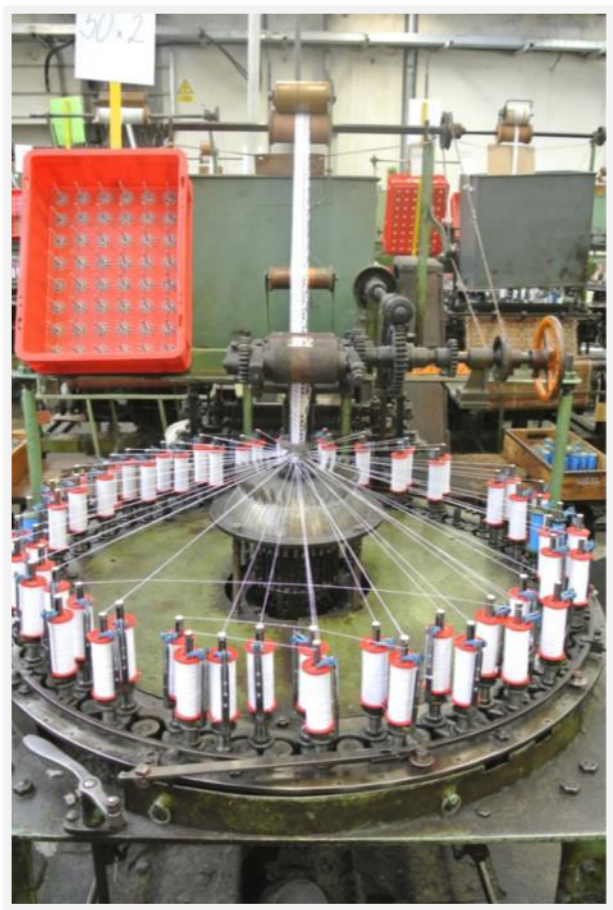
Obrázek 92 Detail odtahového zařízení stroje v průběhu výroby krajky (zdroj: vlastní)
