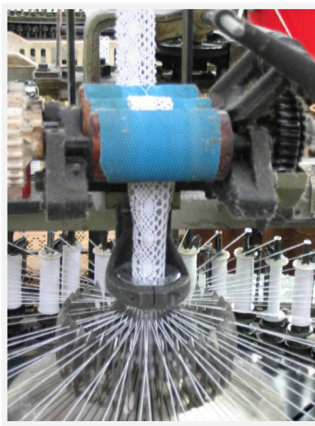
Obrázek 33 Detail odtahového zařízení stroje Karl Mayer [42]
