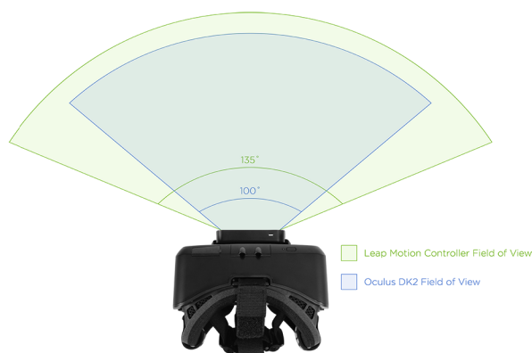
Obrázek 5.1: Rozsah snímání rukou LeapMotion a zorné pole brýlí Oculus Rift DK2
