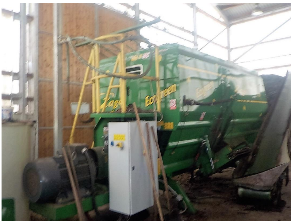
Obrázek č. 7 : Drtící a mísící stroj pro přípravu před kompostováním (foto vlastní zdro)
