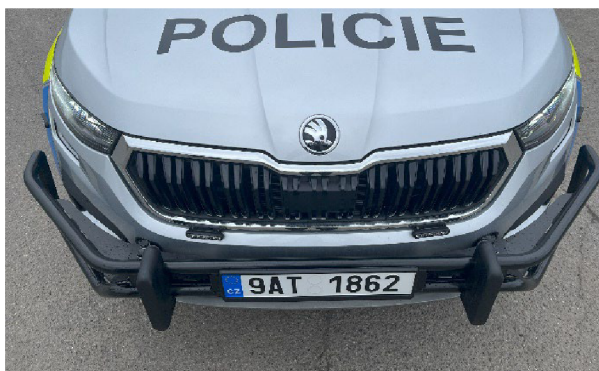
Obrázek 5: Policejní rám umístěný na policejním speciálu 3. generace (Škoda Kodiaq) Zdroj: autor, 2024
