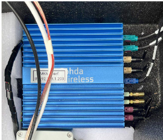
Obrázek 22: OBU jednotka umístěná v „pronásledovaném“ vozidle Zdroj: autor, 2024
