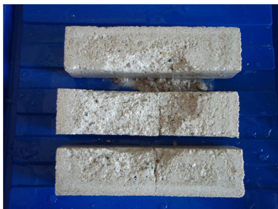
Obr. 58 Zkušební malta REF po 1 zmrazovacím cyklu
