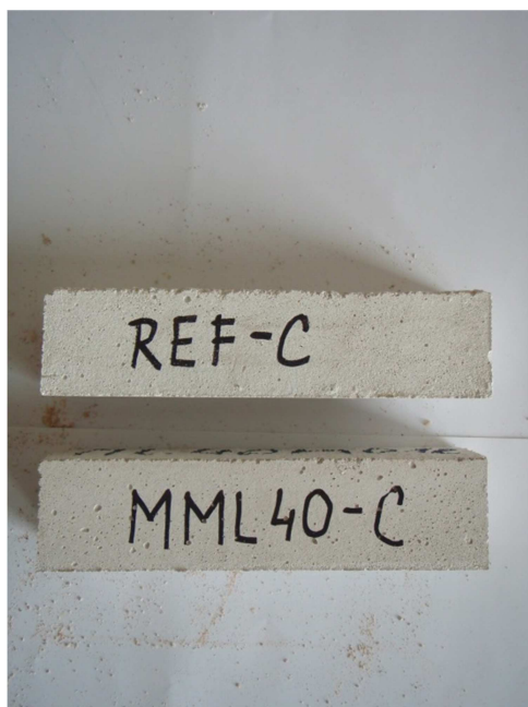
Obr. 111 Zkušební malty REF-C a MML40-C
