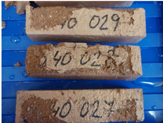
Obr. 66 Zkušební malta MBH40 po 6 zmrazovacích cyklech
