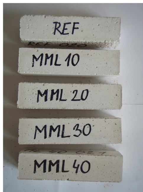
Obr. 54 Zkušební malty REF, MML10, MML20, MML30 a MML40
