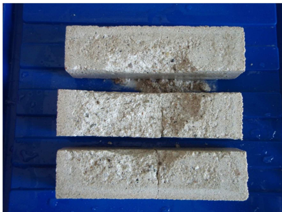
Obr. 117 Zkušební malta REF po 1 zmrazovacím cyklu
