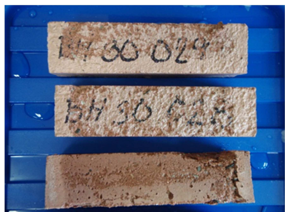
Obr. 65 Zkušební malta MBH30 po 3 zmrazovacích cyklech
