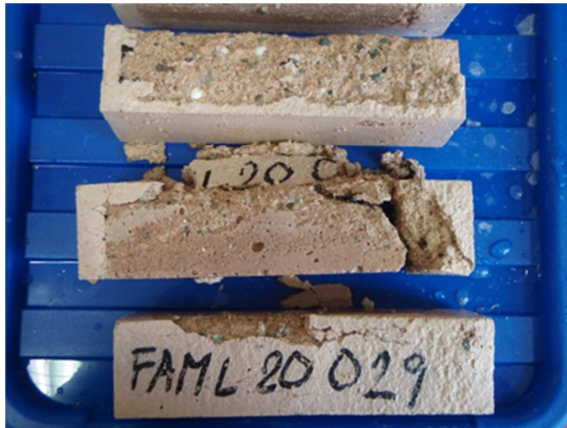
Obr. 60 Zkušební malta MFL20 po 3 zmrazovacích cyklech
