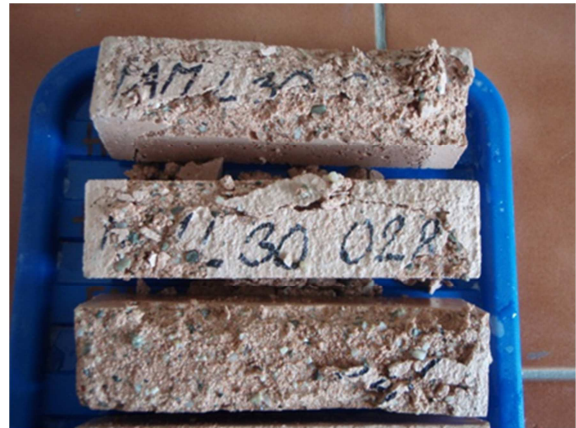
Obr. 61 Zkušební malta MFL30 po 5 zmrazovacích cyklech
