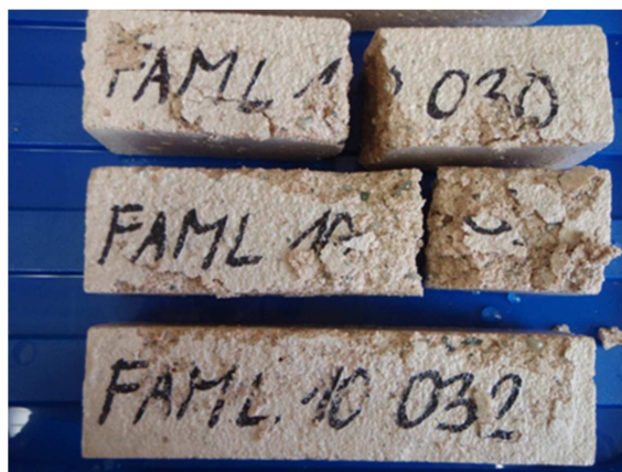
Obr. 59 Zkušební malta MFL10 po 3 zmrazovacích cyklech
