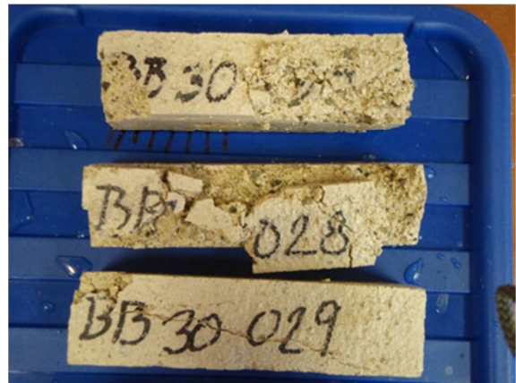
Obr. 63 Zkušební malta MBB30 po 8 zmrazovacích cyklech
