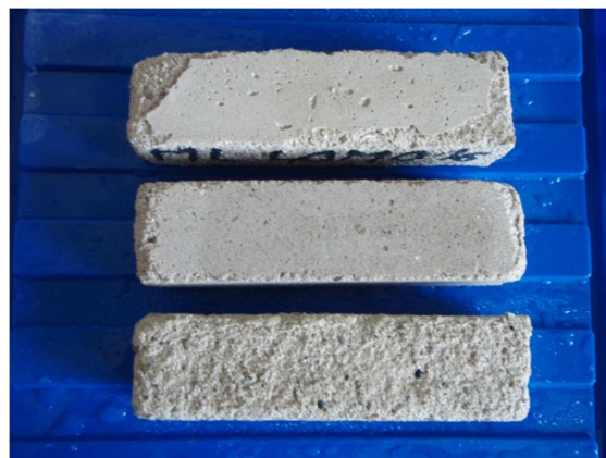
Obr. 119 Zkušební malta MML40-C po 20 zmrazovacích cyklech
