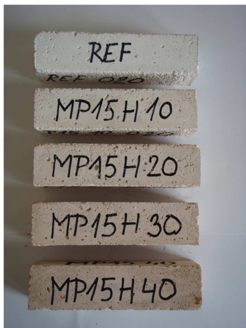
Obr. 49 Zkušební malty REF, MP15H10, MP15H20, MP15H30 a MP15H40
