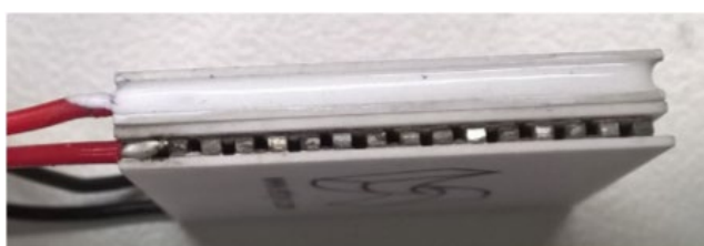
Obr. 14 - Pohľad na termočlánky z boku, hore TEC a dole TEG [14]
