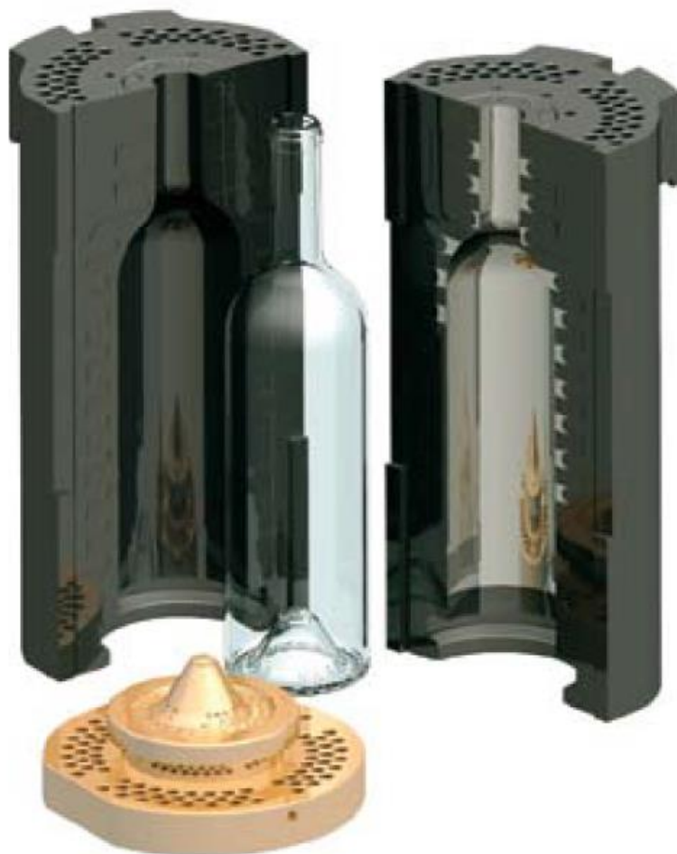
Obr. 3 Strojní tvarovací forma na vinné lahve [4]
