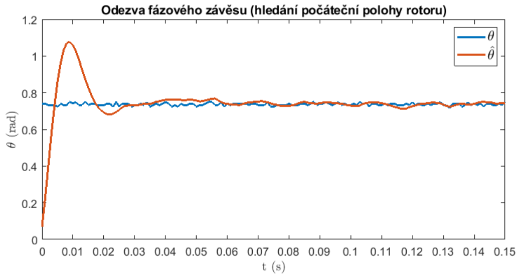
Obr. 7.8: Odezva fázového závěsu (hledání polohy rotoru z nulových podmínek)
