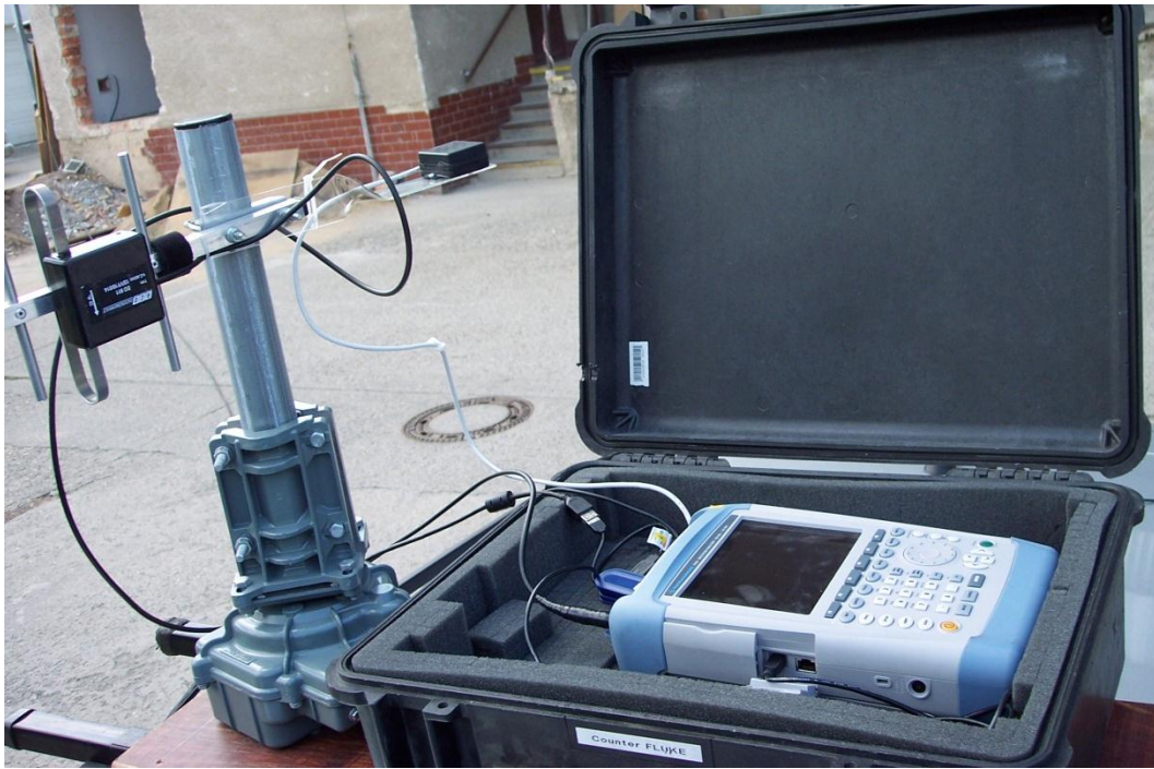
Obr. 25 Detail rotátora, digitálneho kompasu a spektrálneho analyzátora
