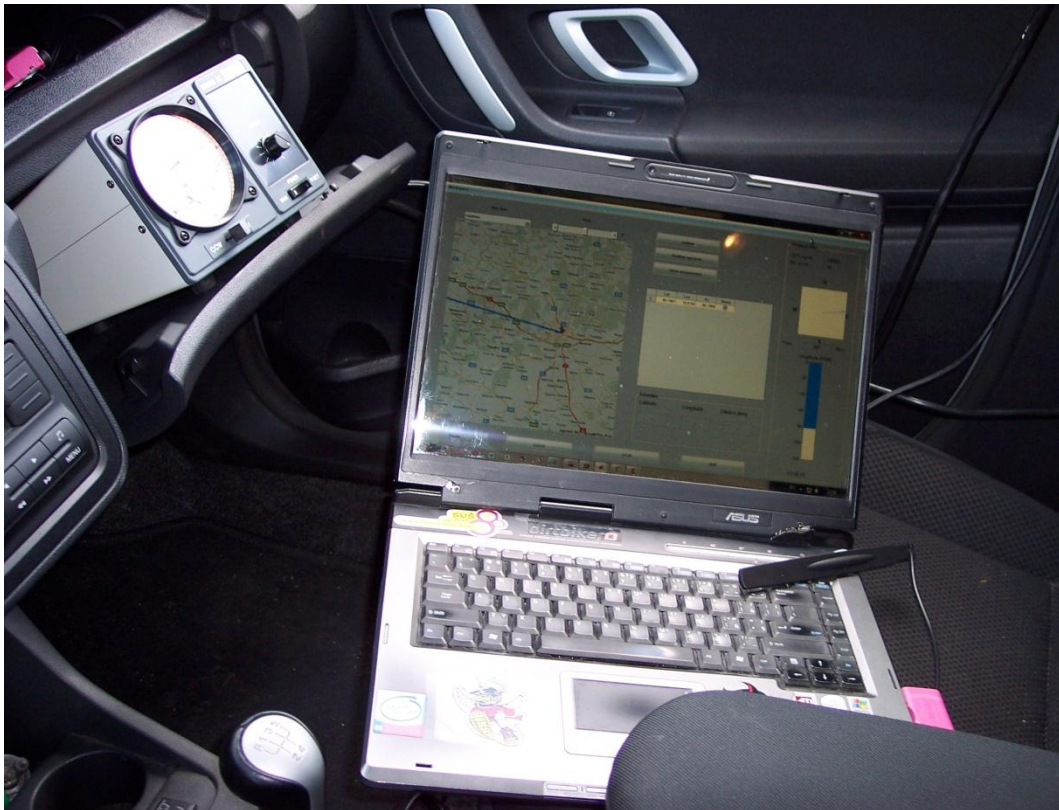
Obr. 26 Riadiace jednotka rotátora a priebeh lokalizácie
