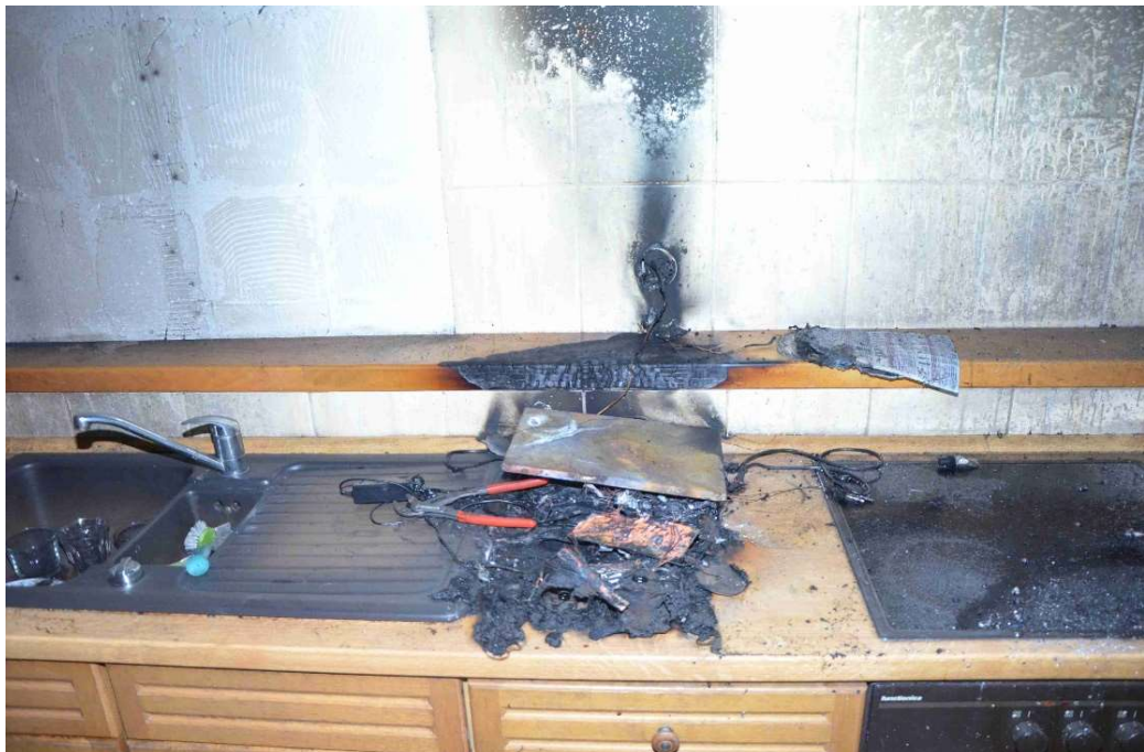
Obrázek č. 2 – Porušení návodu výrobce – ponechání el. cigarety při dobíjení v zásuvce bez dozoru. 11
