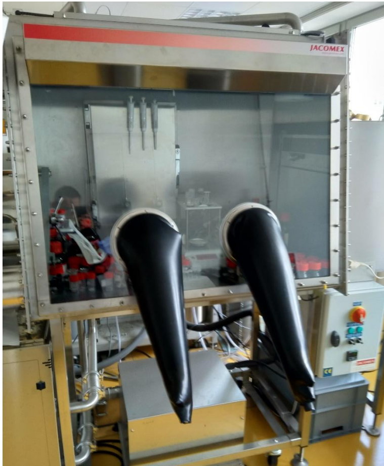
Obrázek 13 - Box s argonovou atmosférou
