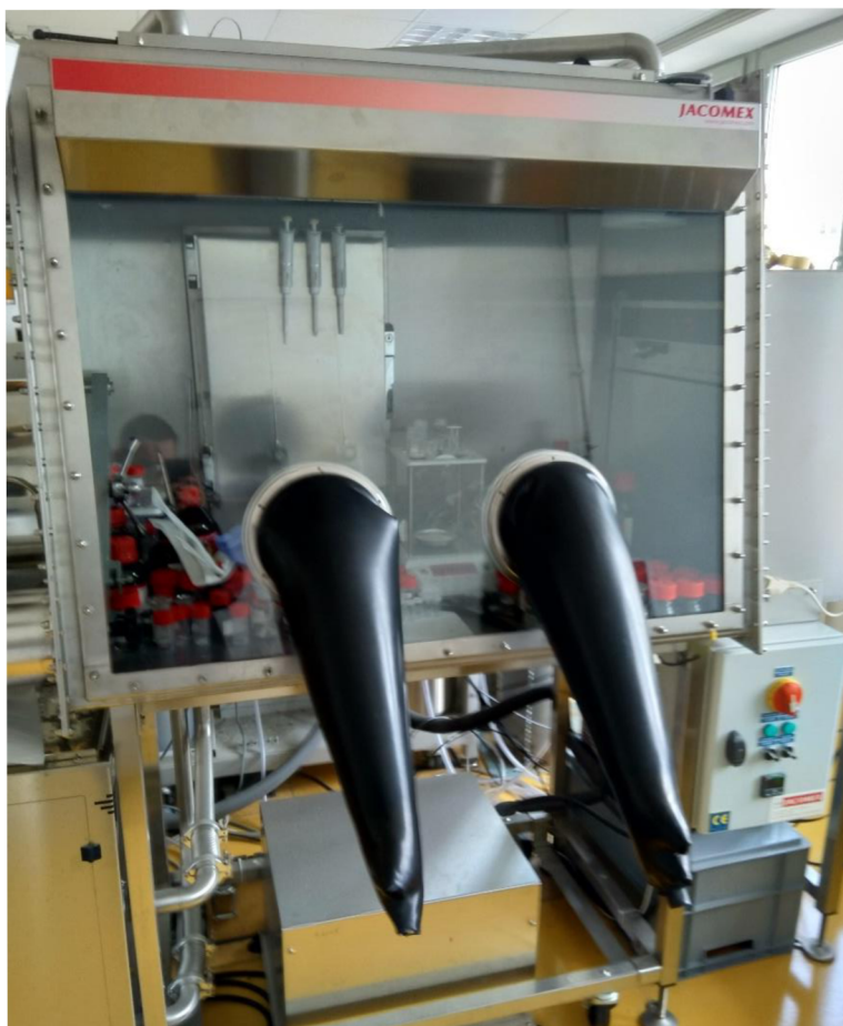
Obrázek 13 - Box s argonovou atmosférou
