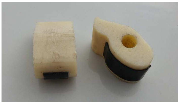
Obr. 25 Úprava povrchu brzdícího segmentu.
