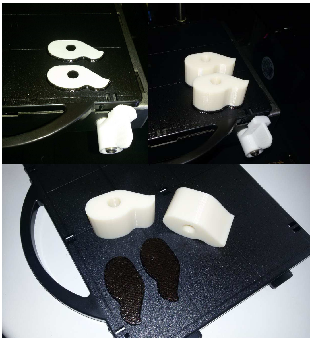
Obr. 24 3D Tisk brzdícího segmentu.
