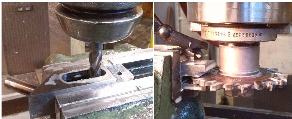
Obr. 21 Frézování prototypu asistenční mechanické brzdy.
