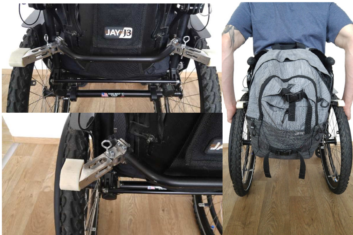
Obr. 33 Umístění asistenční brzdy pro tašku/batoh.
