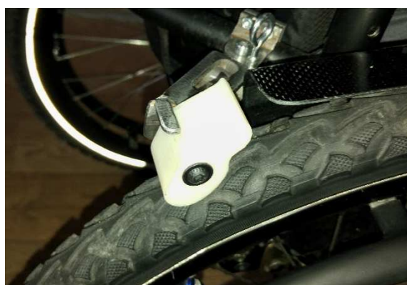
Obr. 40 Úprava konstrukce asistenční brzdy.
