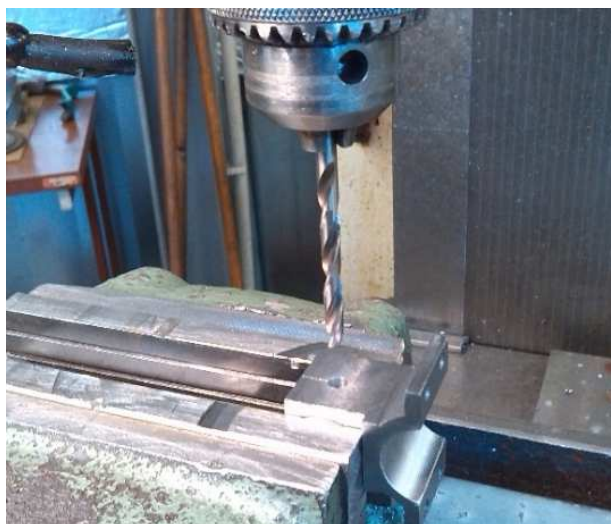
Obr. 22 Vrtání otvoru do části asistenční brzdy.
