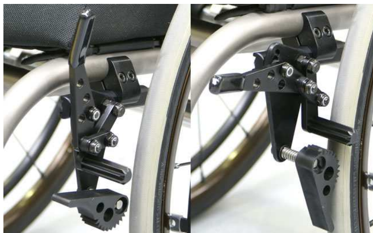
Obr. 10 Brzda s rohatkou [13].
