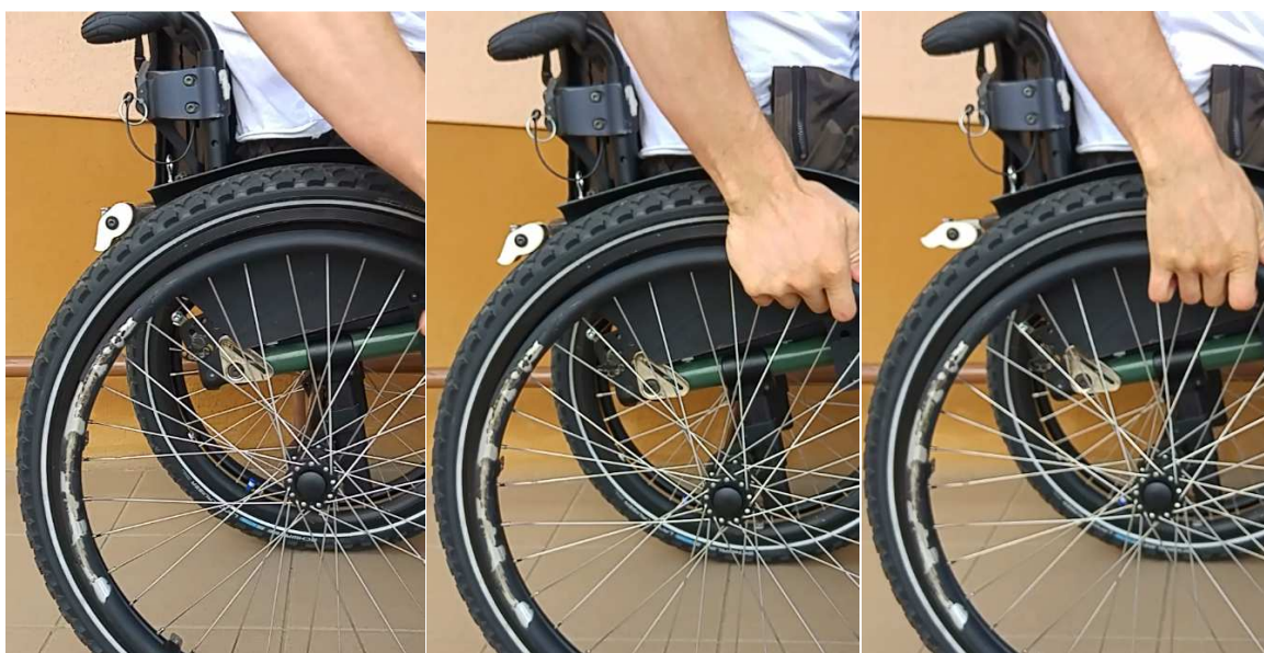
Obr. 43 Pohyb brzdícího segmentu během brzdění.
