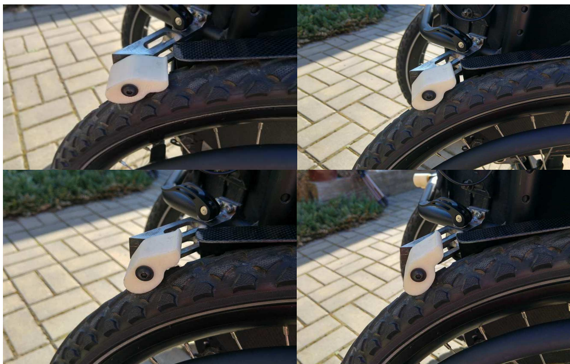
Obr. 38 Rotační pohyb brzdícího segmentu.
