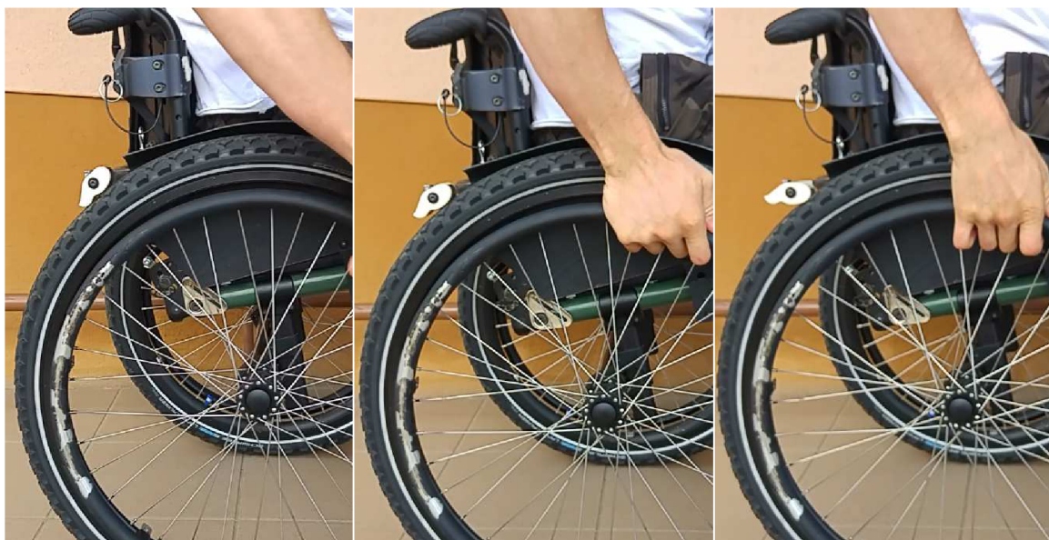
Obr. 43 Pohyb brzdícího segmentu během brzdění.
