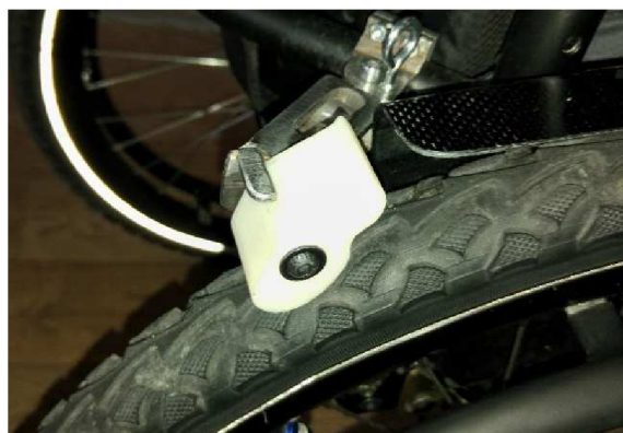
Obr. 40 Úprava konstrukce asistenční brzdy.
