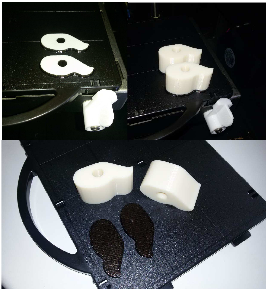
Obr. 24 3D Tisk brzdícího segmentu.
