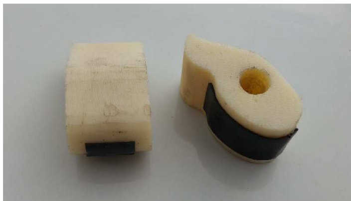
Obr. 25 Úprava povrchu brzdícího segmentu.
