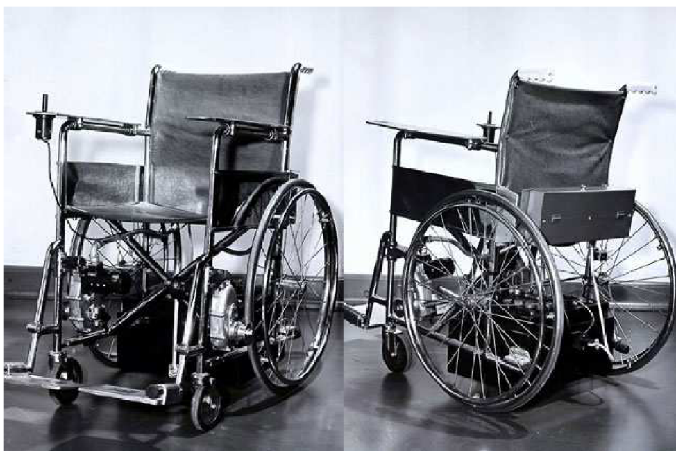
Obr. 3 Elektrický invalidní vozík [6].
