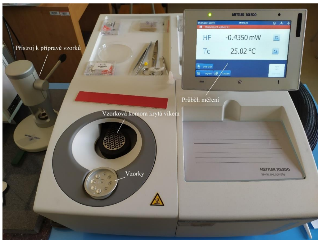
Obrázek 3.9: Fotografie přístroje DSC s kompenzací tepelného toku v průběhu měření
