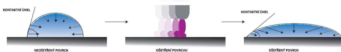
Obrázek 2.9 Princip změny povrchového napětí
