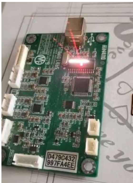
Obrázek 2.6 Čištění DPS laserem
