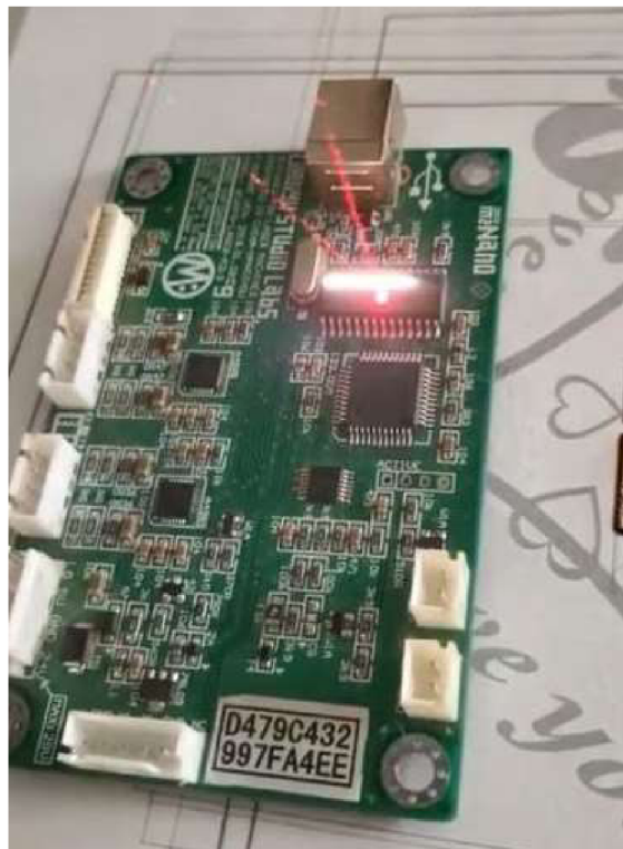
Obrázek 2.6 Čištění DPS laserem
