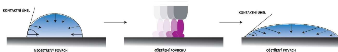
Obrázek 2.9 Princip změny povrchového napětí
