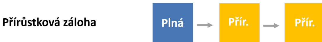
Obrázek 14 Princip funkčnosti přírůstkové zálohy
