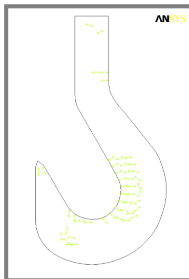
Obr. 44 Vektorové pole druhého hlavního napětí na modelu háku. (výsledky z MKP)
