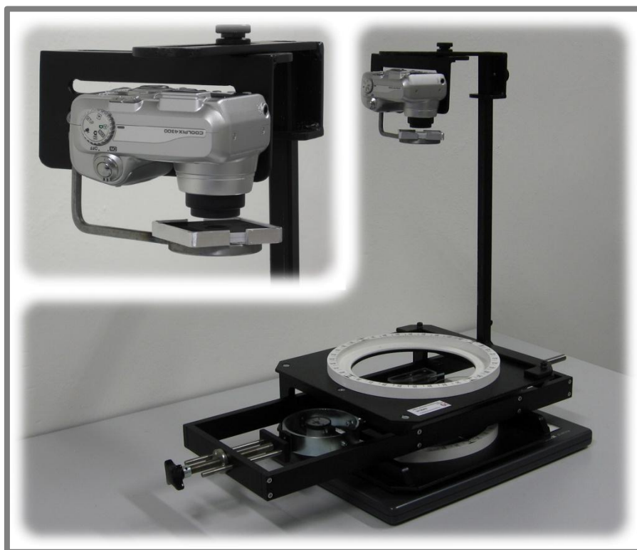
Obr. 38 Polariskop s držákem pro základní a doplňkovou kruhovou polarizaci.
