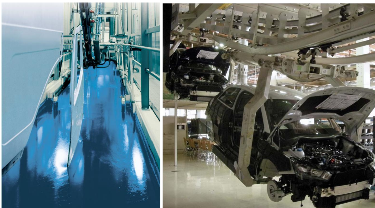
Obr. 2- Použití závěsových dopravníků, vlevo lakovna [20], vpravo montáž vozu [23]
