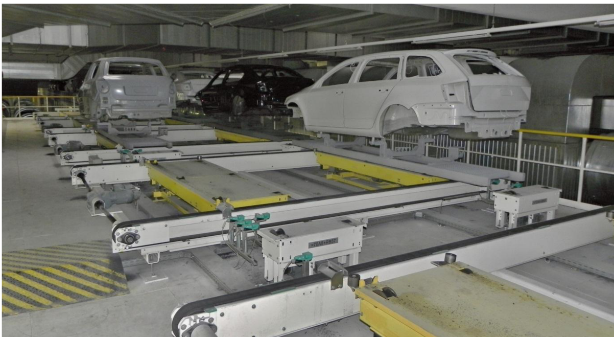
Obr. 2- Příčné pásové dopravníky tvořící zásobník "Barevných Bloků" [22]
