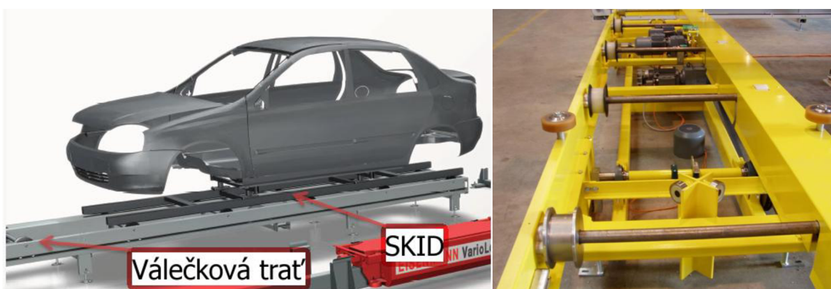
Obr. 2- Válečková trať se skidem (vlevo) [19], detail válečkové dráhy (vpravo) [20]
