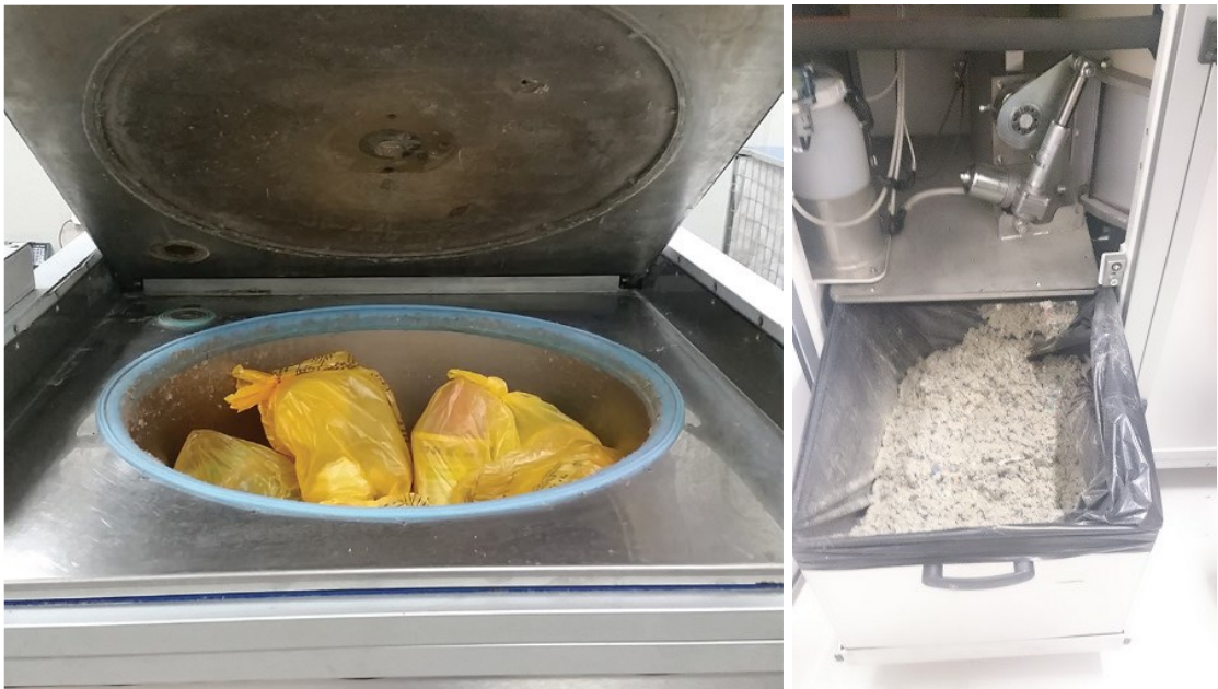
Obr. 3.2 Dekontaminační komora a dekontaminovaný materiál v converteru.
