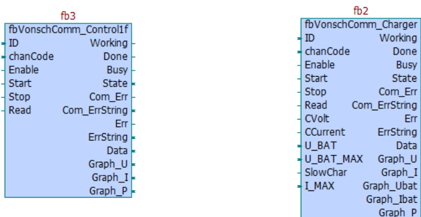
Obrázek 9. Funkční bloky pro ovládání měničů
