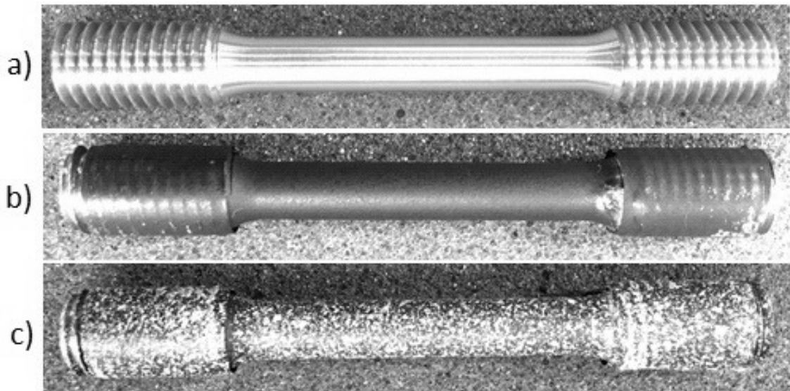
Obr. 26 Příprava vzorků pro fotogrammetrickou metodu měření deformace (a – původní povrch, b – vzorek s černou barvou, c – vzorek s patternem)
