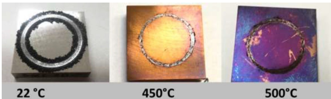
Obr. 45 Stopa opotřebení po tribologických experimentech za teplot 22 °C, 450 °C a 500 °C na vzorcích oceli zpracované metodou SLM
