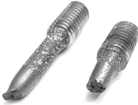
Obr. 30 Charakter lomu po tahové zkoušce pro tvářený materiál - vlevo, pro materiál zpracovaný metodou SLM – vpravo
