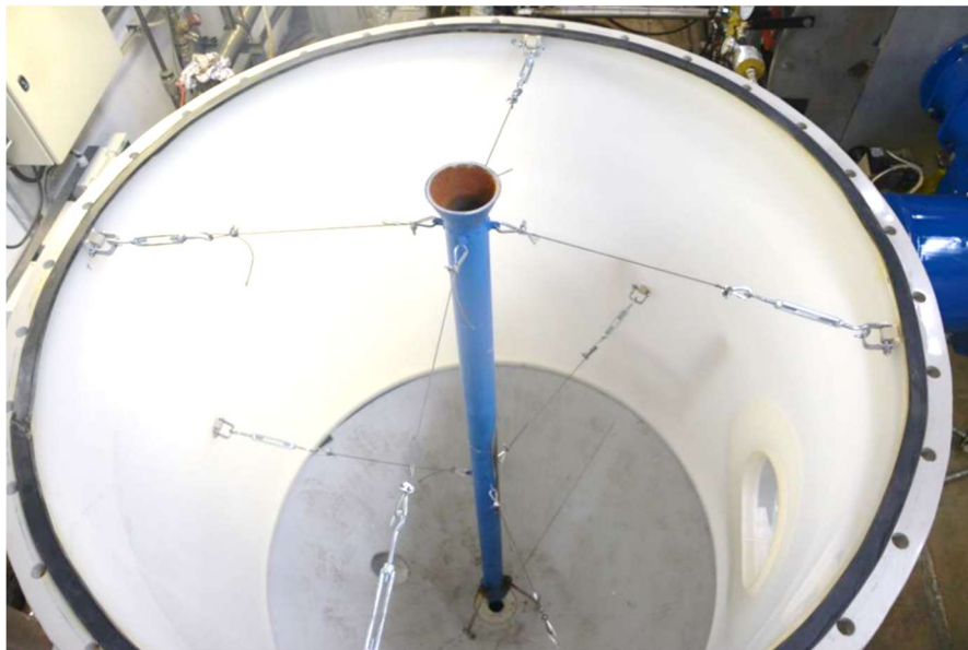
Obr. 31 Uchycení centrální trubky v nádrži.
