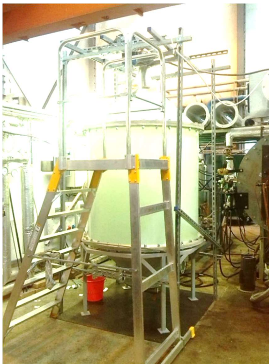
Obr. 32 Sestava modelu nádrže pro experiment.
