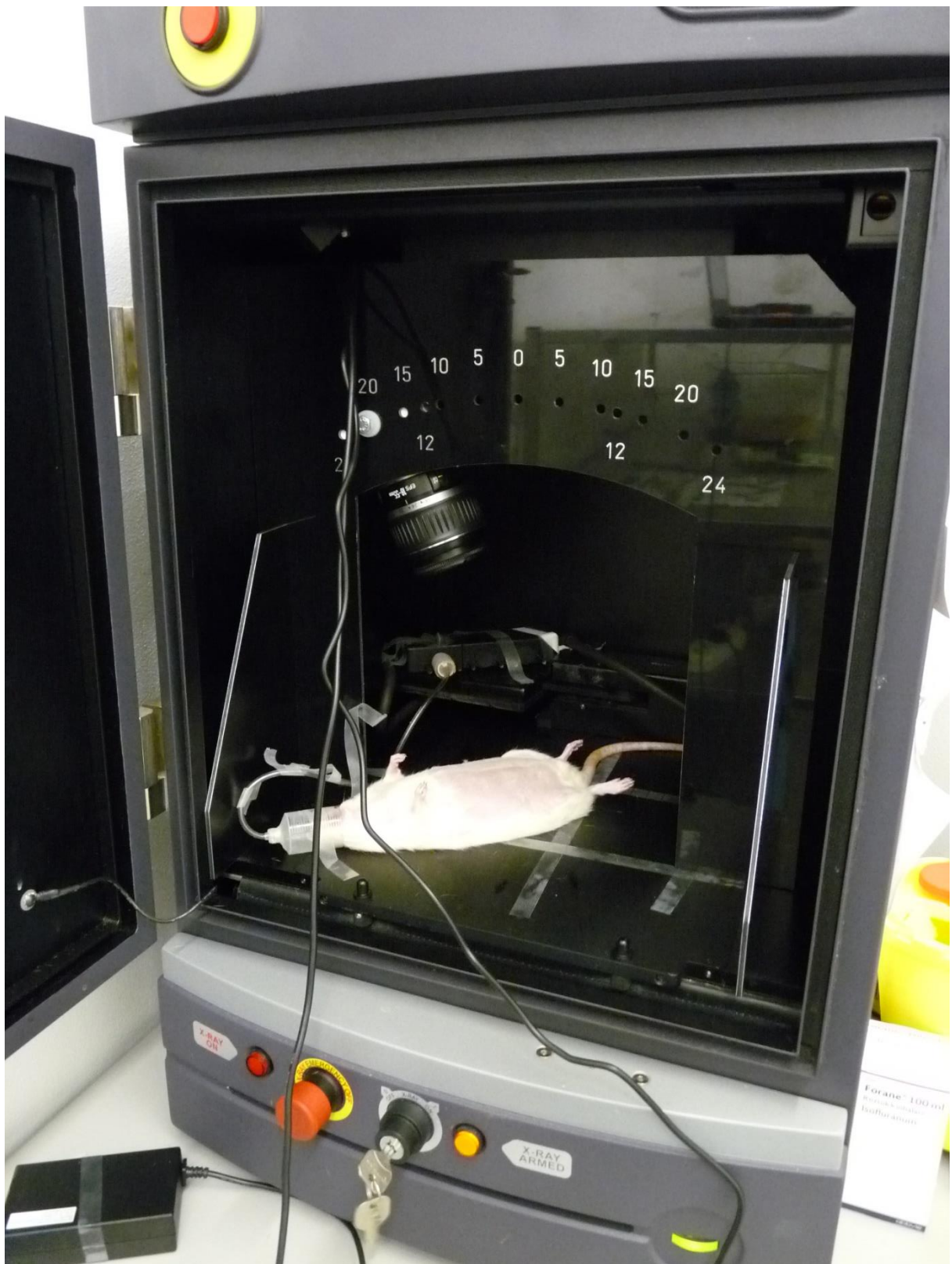
Příloha 25 - držák s kamerou G2-3200 v pozici pro úhel -20^{\circ} se subjektem 2
