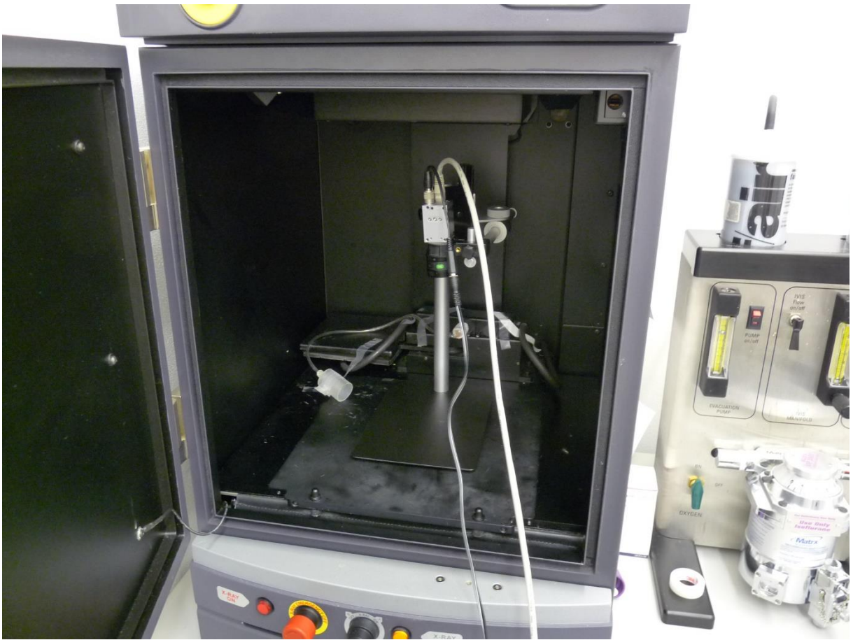
Příloha 15 - IVIS Lumina XR použita jako černý box pro kameru
