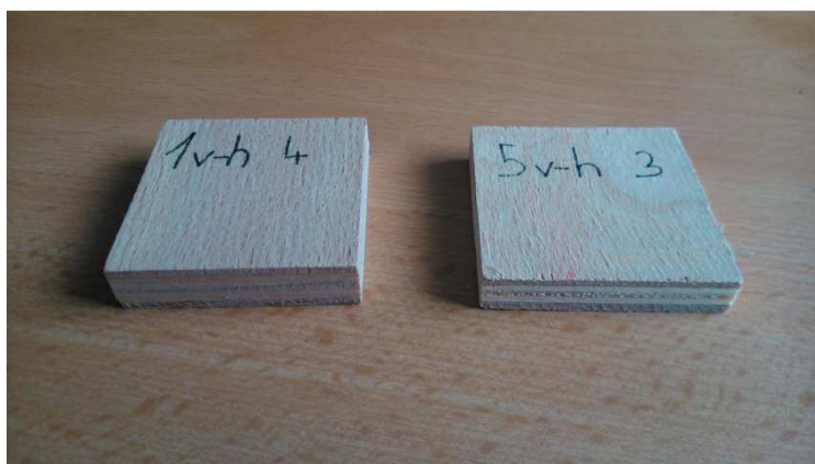
Obr. č. 5: Zkušební vzorky pro vlhkost a hustotu
