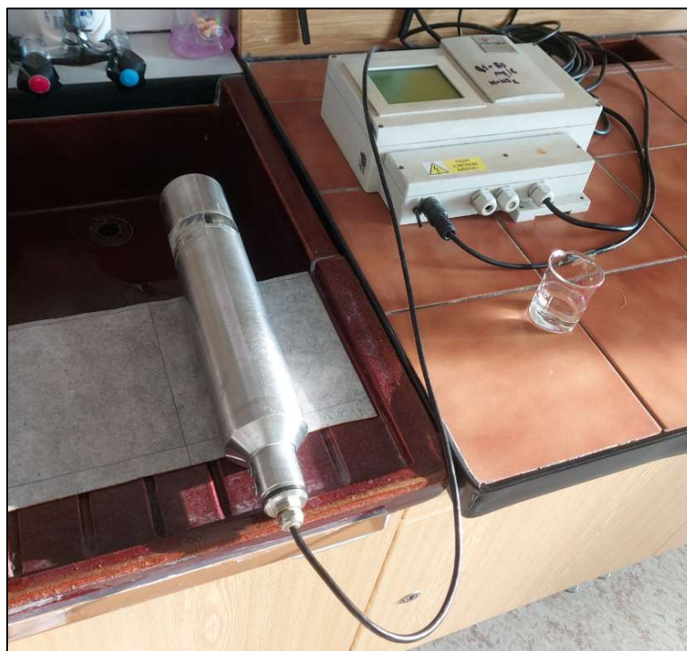
Obr. 6) Měření pomocí sondy DR LANGE-MULTIUNIT PLUS
