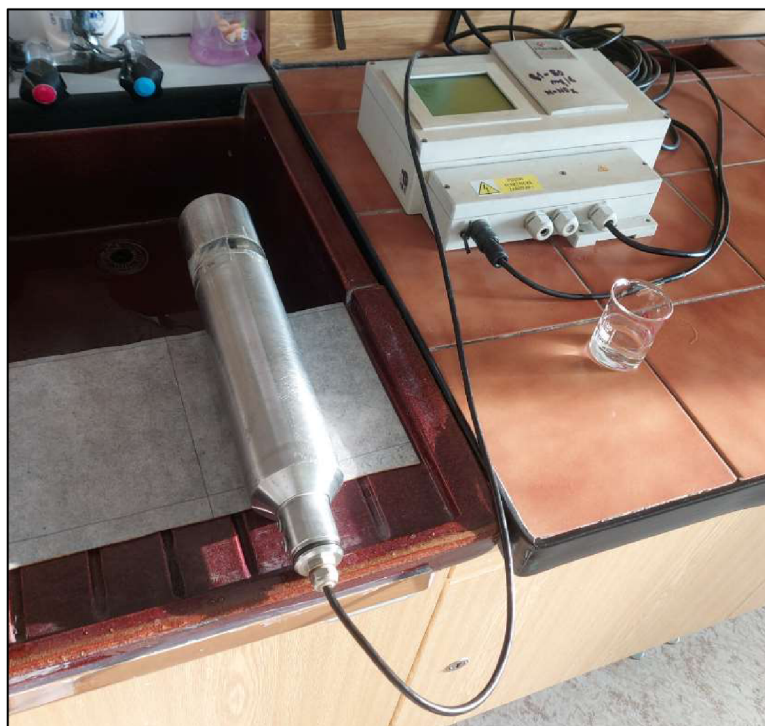
Obr. 6) Měření pomocí sondy DR LANGE-MULTIUNIT PLUS
