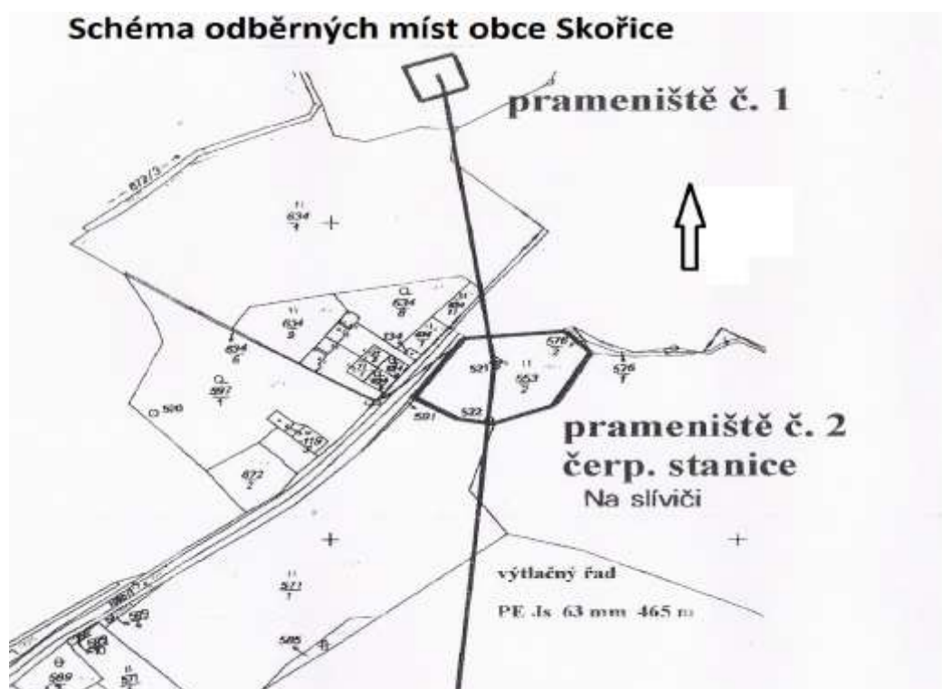
Obrázek č. 10: Schématické znázornění odběrných míst (Provozní řád vodovodu Skořice)
