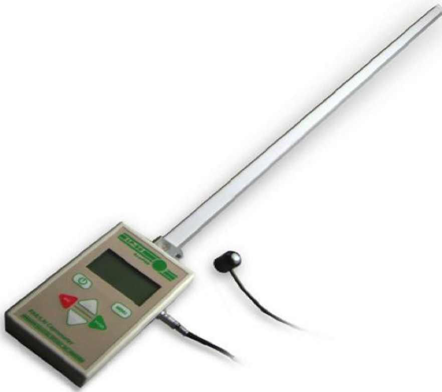
Příloha č. 3 Ceptometr Decagon LP-80, sloužící k měření LAI
