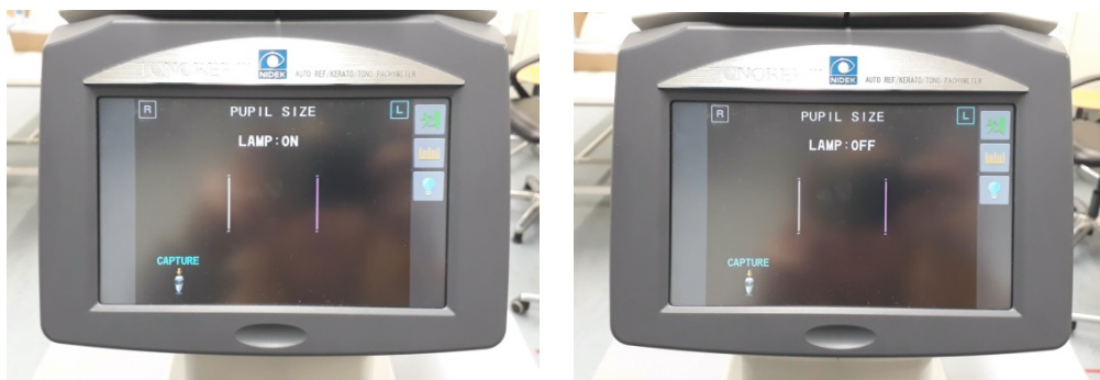
Obr. 18 – Nastavení přístroje pro měření s osvětlením (vlevo) a za tmy (vpravo).
