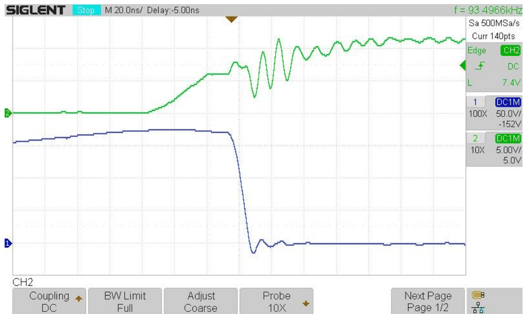
Obrázok 26 Detail zapínacieho deja výkonového tranzistora
