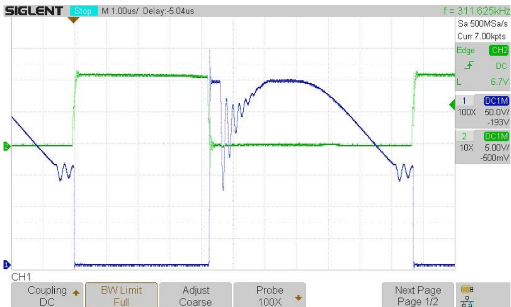
Obrázok 24 Priebehy na riadiacej elektróde a draine výkonového tranzistora so záťažou
