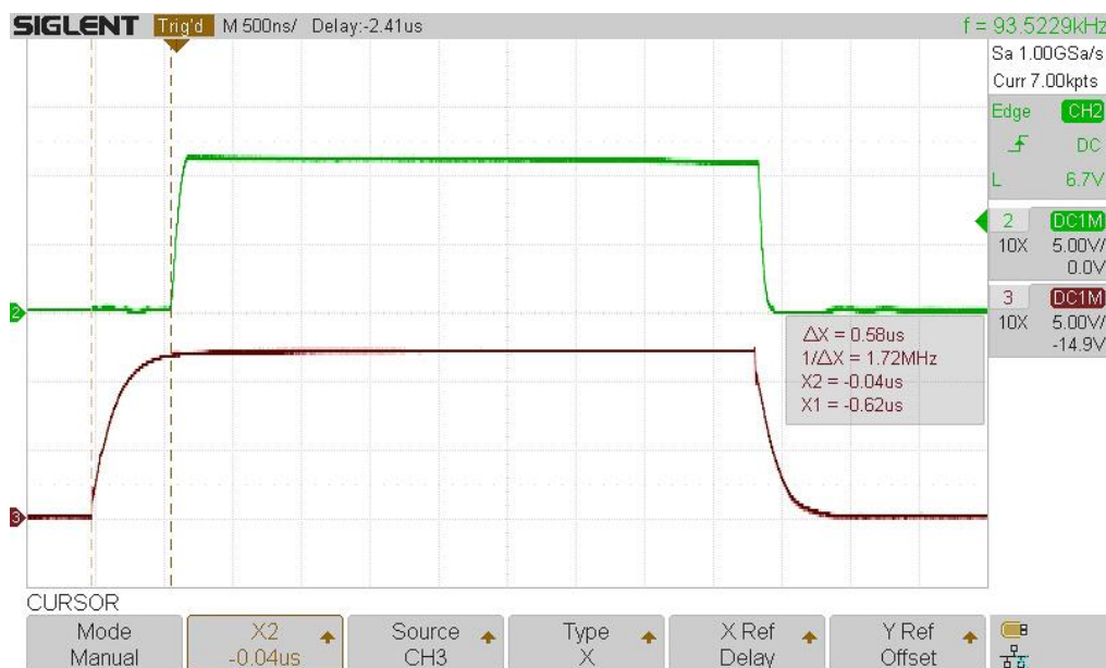
Obrázok 22 Priebehy na riadiacich elektródach dolného výkonového tranzistora primárnej strany a usmerňovacieho tranzistora
