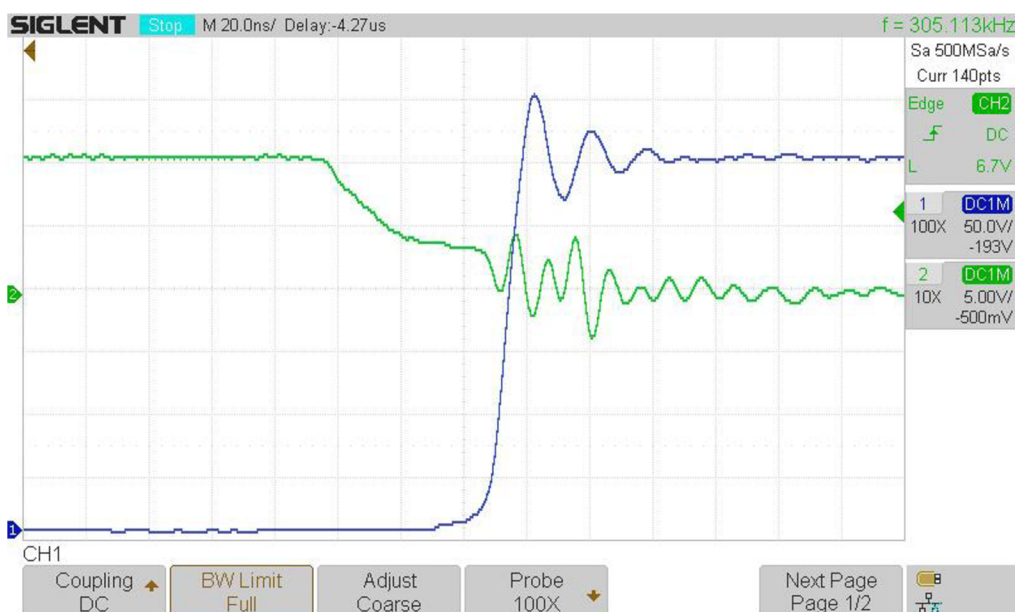
Obrázok 25 Detail vypínacieho deja výkonového tranzistora
