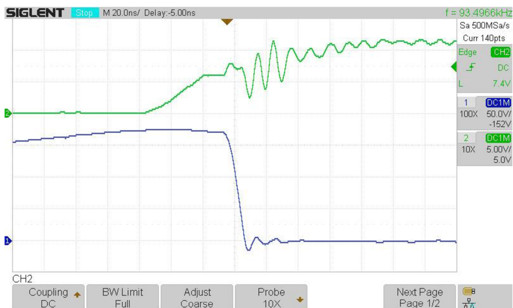
Obrázok 26 Detail zapínacieho deja výkonového tranzistora
